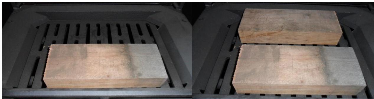
**Druhou vrstvu palivového dřeva umístěte příčně dle obrázků. Rozestupy mezi jednotlivými kusy dřeva by měly činit cca 2 cm.**
