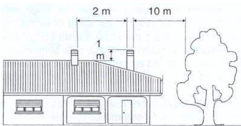
Rozměry komína se liší podle modelu. Ovšem, kvůli zabezpečení dobrého průtoku kouře musí být část otvoru na vzdach na jeho výstupu vždy dvakrát větší než povrch kouřovodu, zatímco kryt komína nikdy nesmí bránit průtoku vzduchu.
