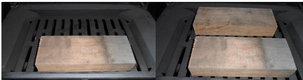
**Druhou vrstvu palivového dřeva umístěte příčně dle obrázků. Rozestupy mezi jednotlivými kusy dřeva by měly činit cca 2 cm.**
