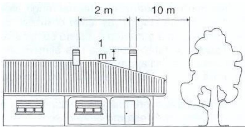
Rozměry komína se liší podle modelu. Ovšem, kvůli zabezpečení dobrého průtoku kouře musí být část otvoru na vzdachu na jeho výstupu vždy dvakrát větší než povrch kouřovodu, zatímco kryt komína nikdy nesmí bránit průtoku vzduchu.
