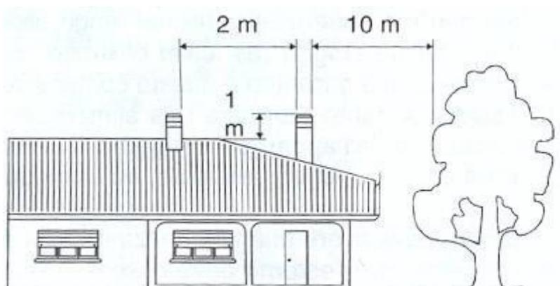
Rozměry komína se liší podle modelu. Ovšem, kvůli zabezpečení dobrého průtoku kouře musí být část otvoru na vzduch na jeho výstupu vždy dvakrát větší než povrch kouřovodu, zatímco kryt komína nikdy nesmí bránit průtoku vzduchu.
