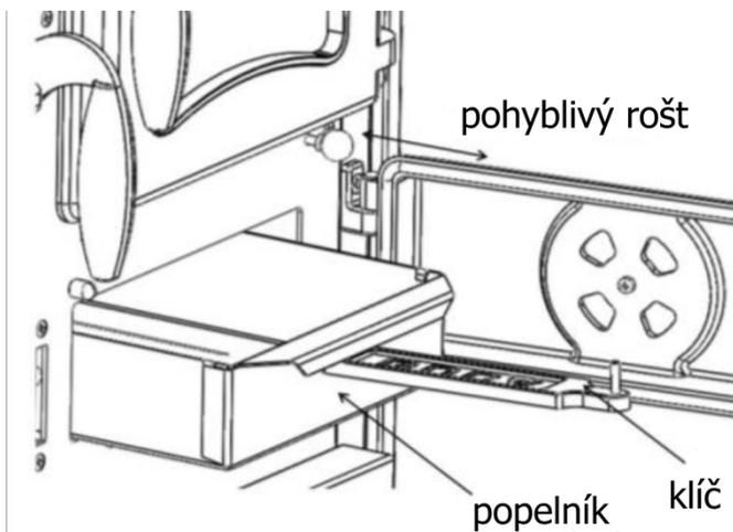
**Čištění kanálku pro tok plynných spalin pod troubou se provádí následujícím způsobem:** Odstraňte dekorativní desku (pod dvířky trouby) - odstraňte vrstvy sazí ze dna kamen a pod dnem trouby. Po vyčištění vraťte dekorativní desku a zašroubujte ji pevně zpět, jak lze vidět na obrázku.
