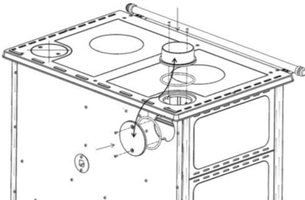
Pokud chcete, aby odvod kouře byl ze zadní strany, odstraňte šrouby spojující kryt odvodu se zadní stranou sporáku a na tom místě připevněte šrouby přípojku na odvod kouře. Kryt pomocí šroubů spojte s rámem sporáku na určeném místě. Dávejte pozor, aby těsnění, která se nacházejí na krytu a přípojce byla v kanálcích a dostatečně připevněná, aby se tak zabránilo průniku kouře.
