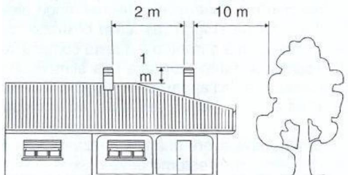
Rozměry komína se liší podle modelu. Ovšem, kvůli zabezpečení dobrého průtoku kouře musí být část otvoru na vzduch na jeho výstupu vždy dvakrát větší než povrch kouřovodu, zatímco kryt komína nikdy nesmí bránit průtoku vzduchu.
